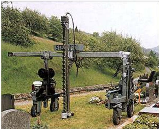
Das als Zubehör lieferbare Lafettenerdbohrgerät wird vom Steinlift selbst aufgenommen. Fundamentbohrungen bis zu  $\varnothing$  20 cm und einer Tiefe von 2,6 Metern werden damit zielgenau und völlig mühelos gebohrt.
